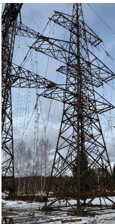
Рис. 10. Испытание анкерной опоры У110-2РН в 2025 г.
