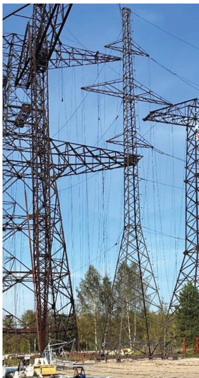
Рис. 9. Испытание промежуточной опоры П110-2РН в 2024 г.
