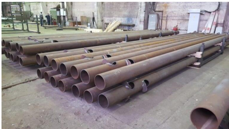
Сваи из металлических труб \varnothing 219 , \varnothing 325 и \varnothing 426 мм
