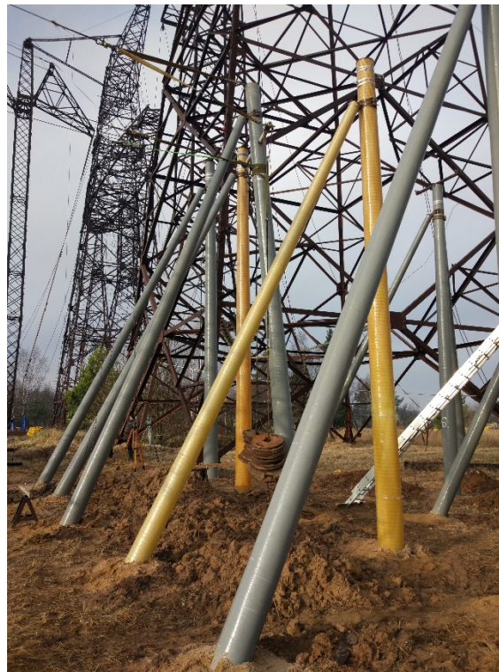
Испытания анкерно-угловых опор на базе ОРГРЭС
