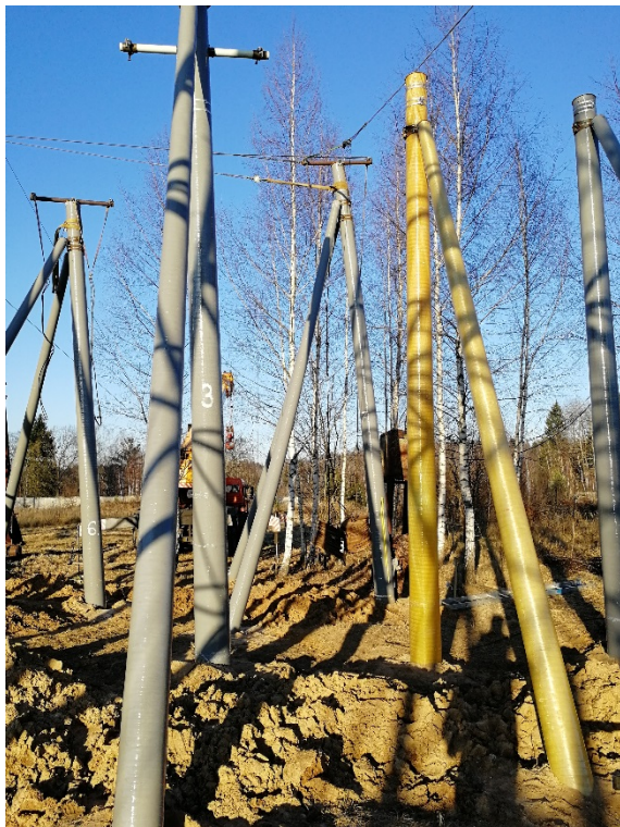
Испытания анкерно-угловых опор на базе ОРГРЭС
