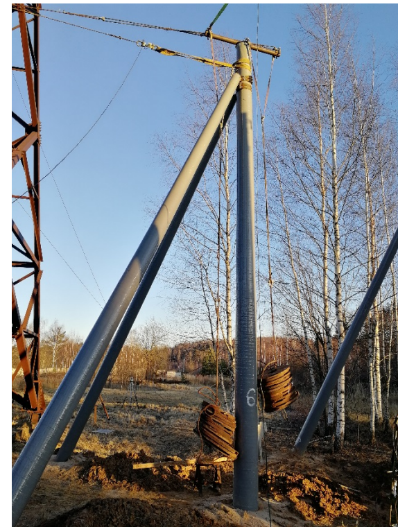
Испытания анкерно-угловых опор на базе ОРГРЭС
