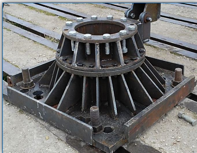
Узел крепления к силовому полу
