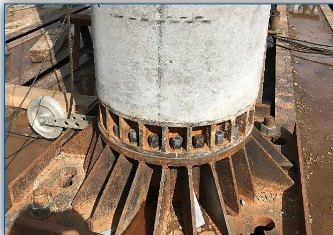
Узел крепления к силовому полу
