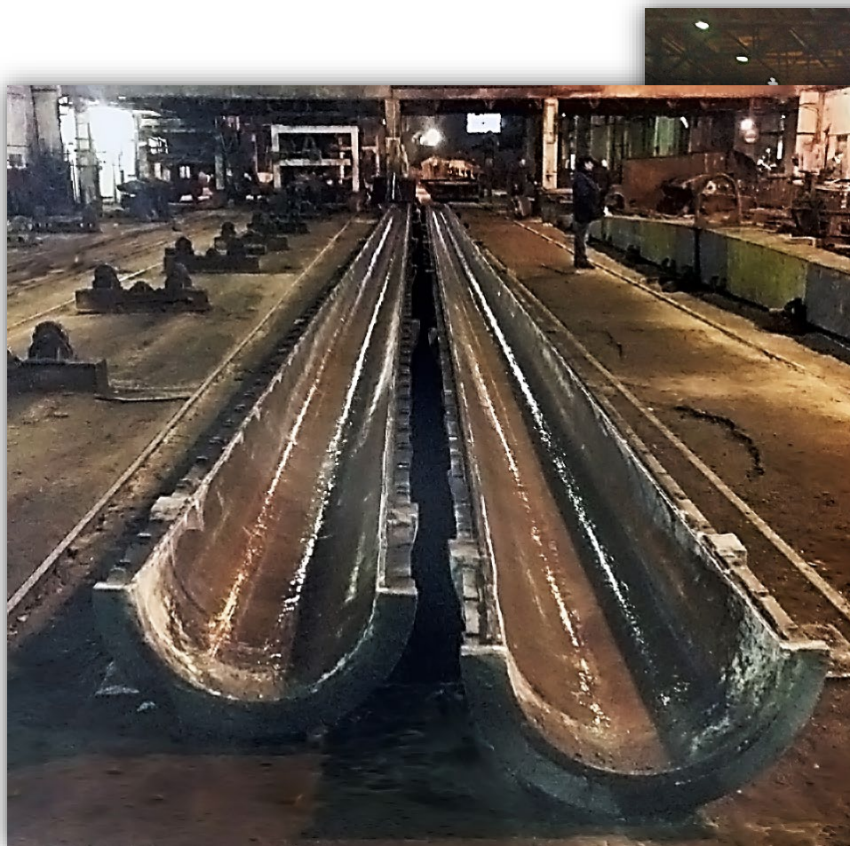
Разъёмная металлоформа для изготовления стоек
