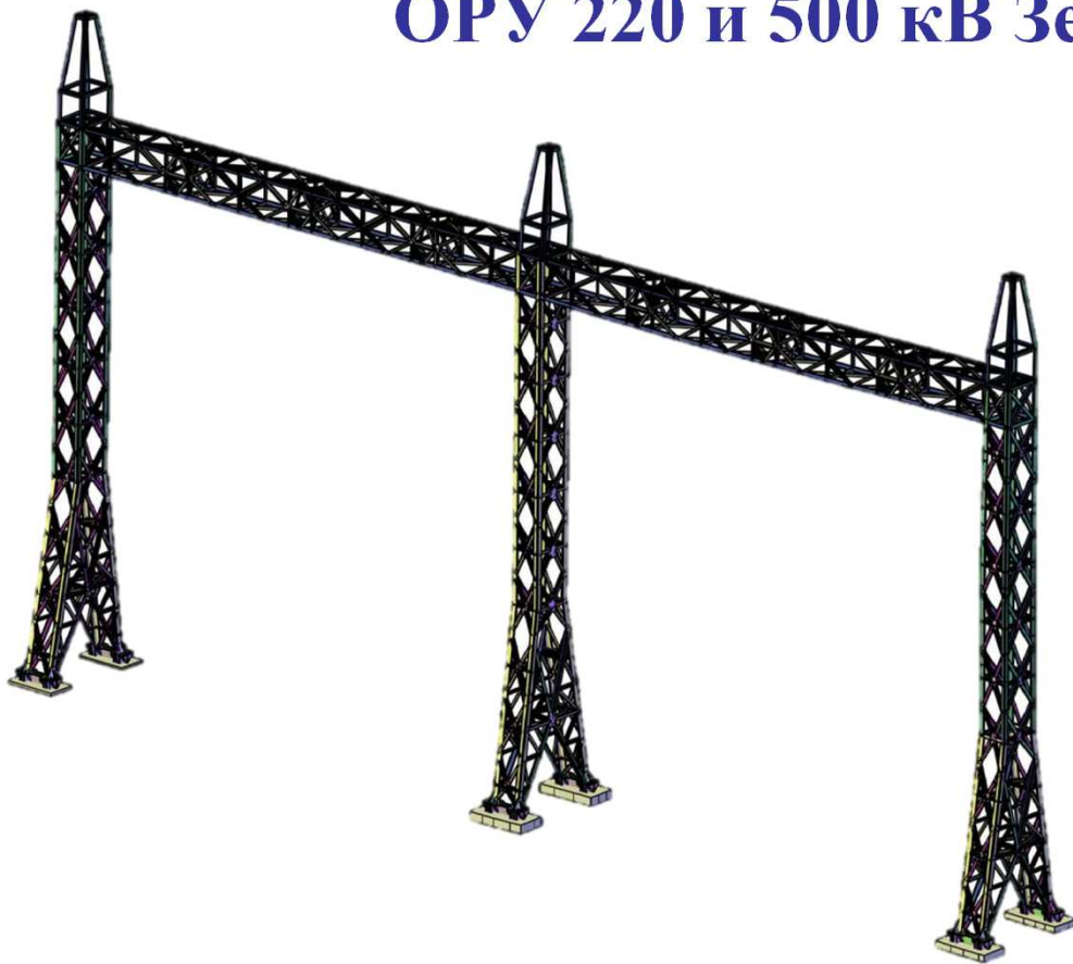
Трёхмерная модель портала с указанием сортамента элементов при помощи таблицы слоев
