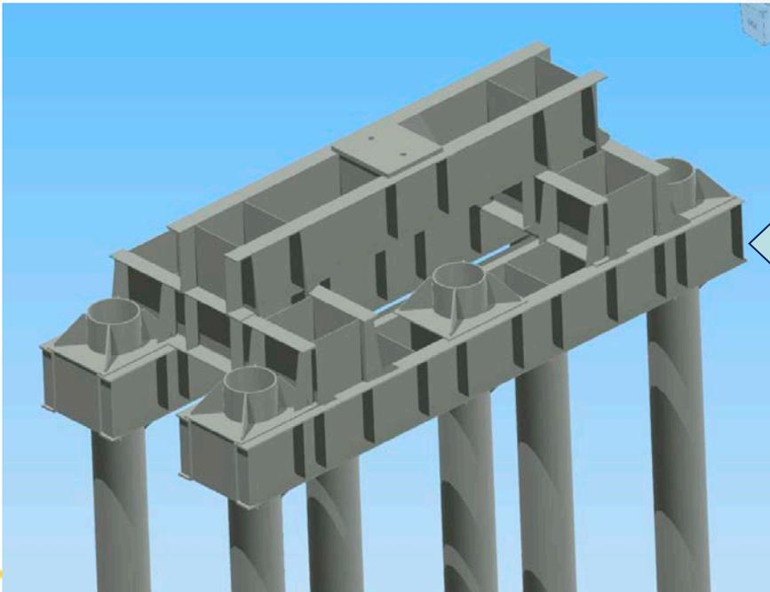
**6 свайный фундамент на винтовых сваях со сварным металлическим ростверком**
