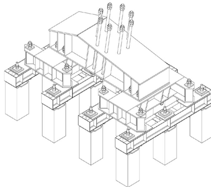
**12 свайный фундамент на забивных сваях с болтовым металлическим ростверком**
