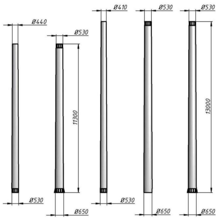
Конические стойки Ø650 мм
