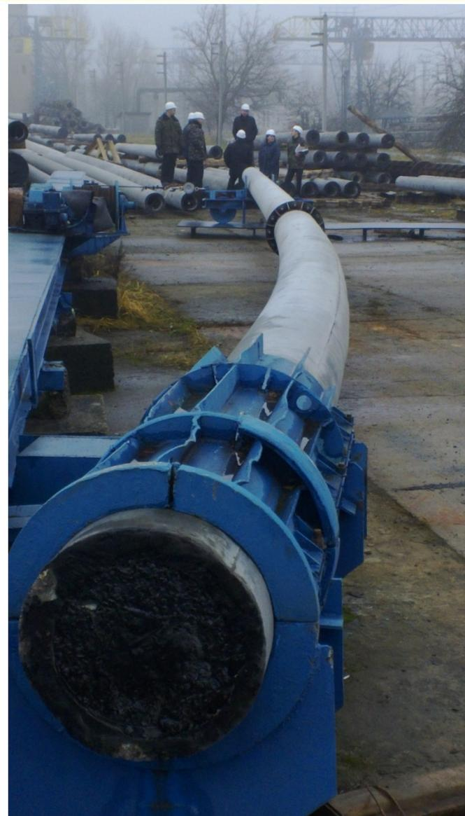
1. Фланец с рёбрами приваривается после выемки из опалубки.
