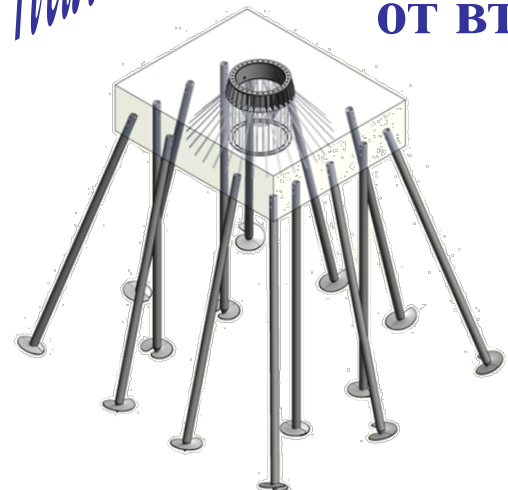
Фундамент из винтовых свай для многогранной опоры
