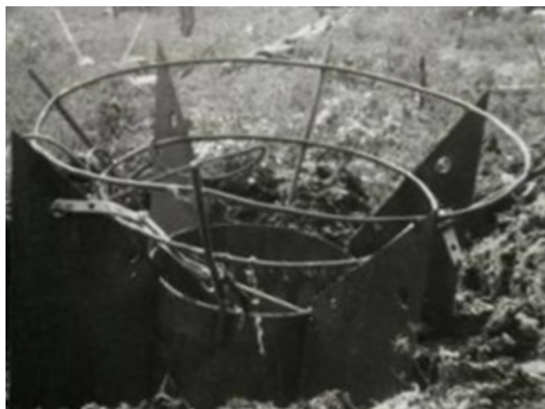
Рисунок 2. Эксперимент по сбросу специального полого фундамента SF-1 весом 1,3 тонны при помощи вертолета Ми-8 в песчаные почвы с высоты 190 м (Сургут, 17.07.1992)
