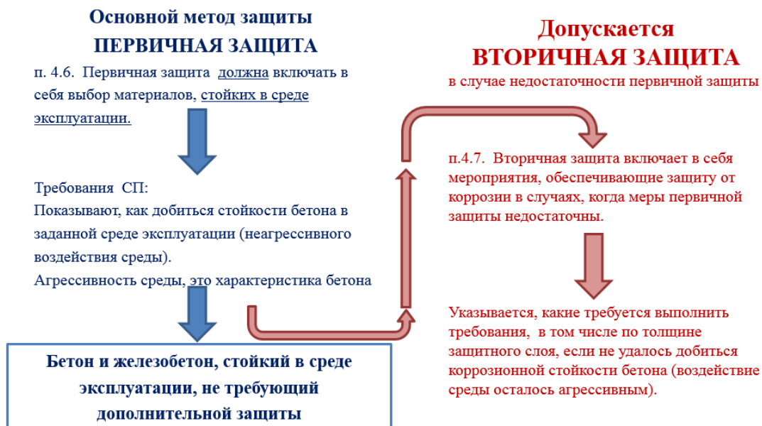
Рис. 1 – Подход к защите бетона и железобетона от коррозии в соответствии с СП 28.13330.2017 «Защита строительных конструкций от коррозии»
