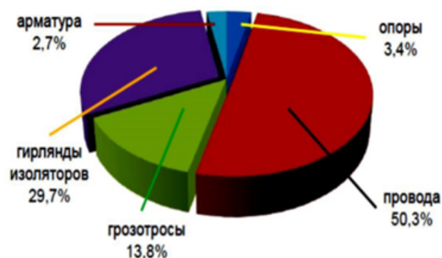
Рис.1 Повреждаемость элементов ВЛ
