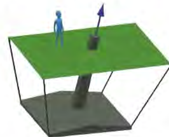
Рис. 2. Схема к определению основания выдергиваемого фундамента
