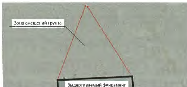
Рис. 4. Муаровый эффект над моделью выдергиваемого фундамента
