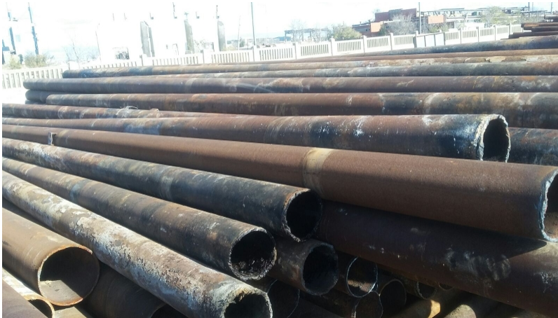
фундаменты из металлических труб диаметром 219 мм, 325 мм или 426 мм
