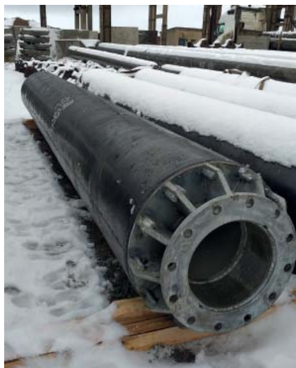
Рис. 3. Фундаментная секция промежуточной опоры СПБ110-8Ф для заходов ВЛ на ПС 110 кВ «Ясень»
