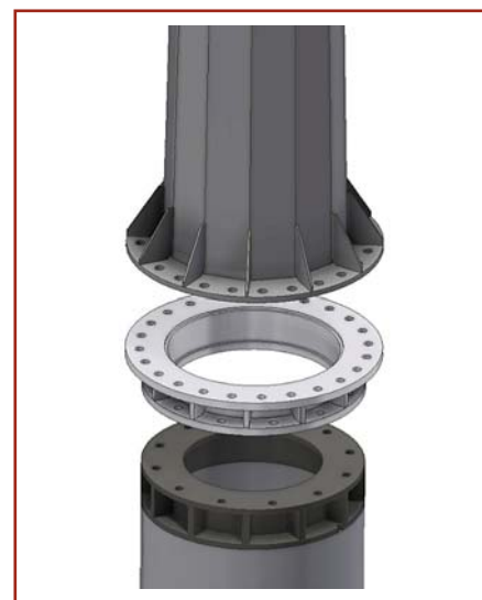
Рис. 7. Переходной элемент для закрепления многогранных опор на железобетонном фундаменте
