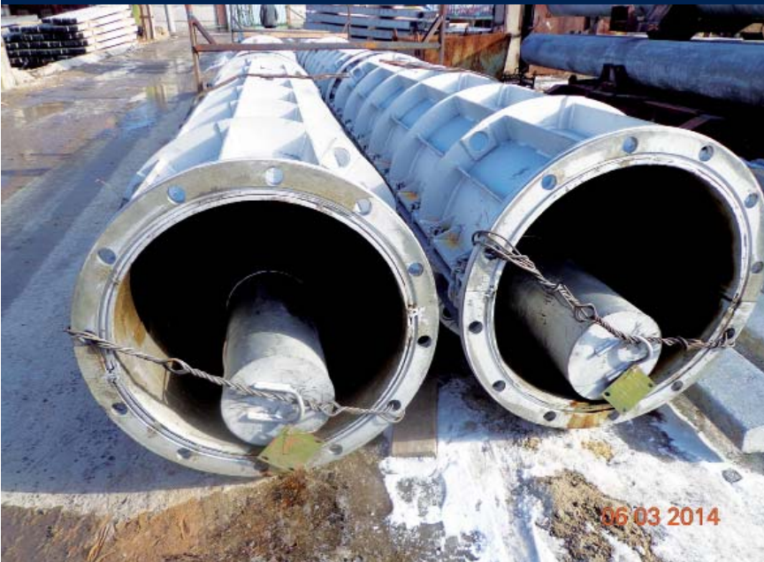
Рис. 3. Металлоформы для изготовления железобетонных центрифугированных секций диаметром 800 мм на заводе «Рыбинскэнергожелезобетон», г. Рыбинск
