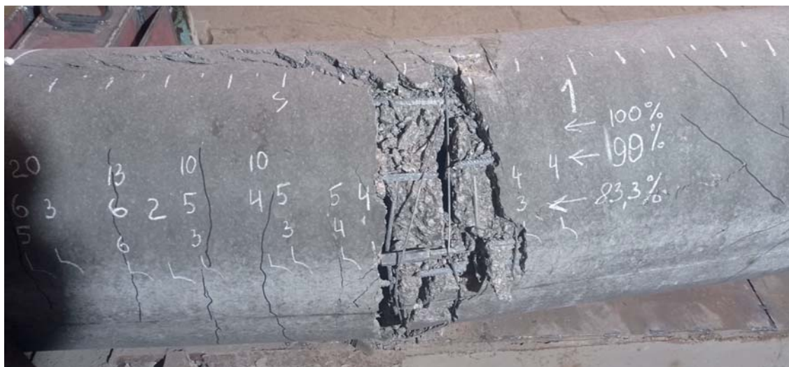
Рис. 12. Схема излома стойки СКЗ со стороны растянутой зоны Fig. 12. Diagram of the SK3 pole fracture on the side of the tensile zone
