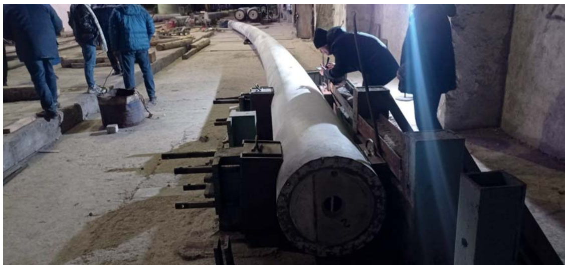
Рис. 14. Стойка в деформированном состоянии перед разрушением Fig. 14. Deformed pole prior the destruction
