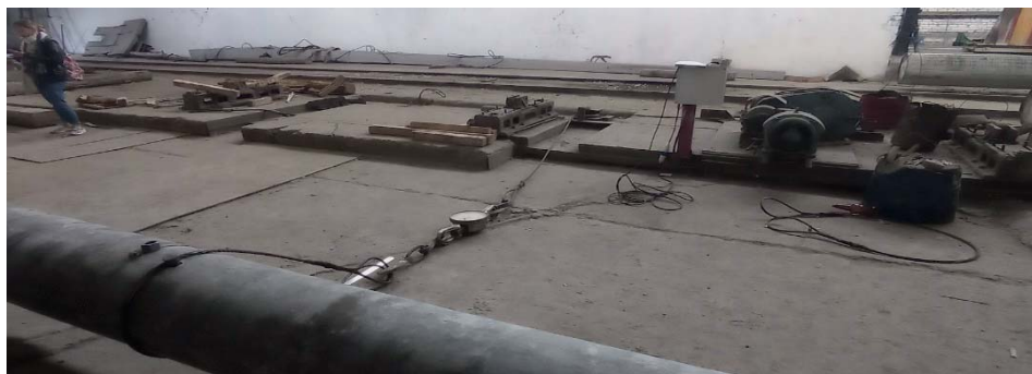
Рис. 10. Фрагмент стенда в месте приложения нагрузки Fig. 10. Fragment of the test bench in the place of the load application
