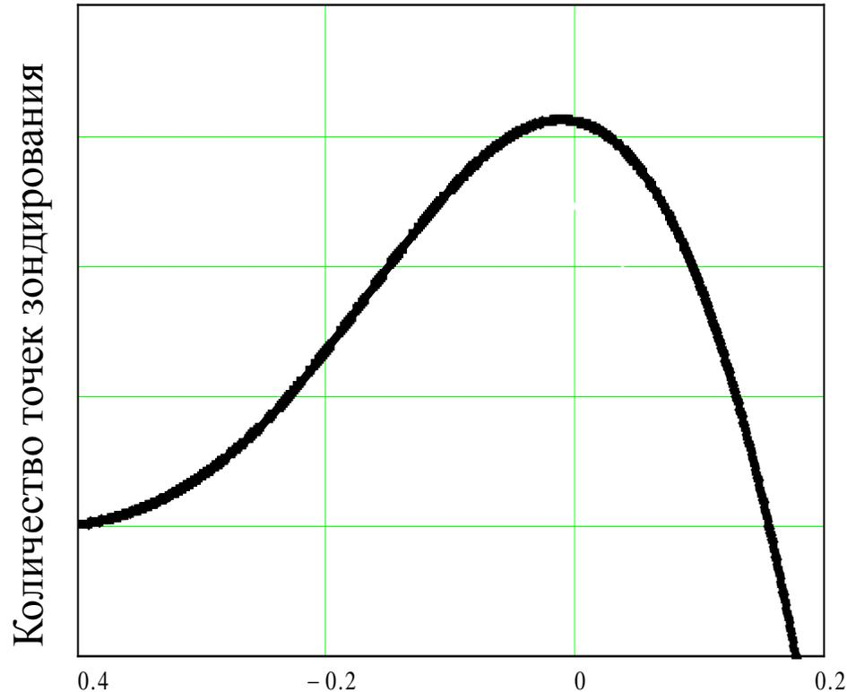
Огибающая гистограммы относительного отклонения (доли единицы) расчетного сопротивления грунта основания  $R$  по данным статического зондирования к расчетному сопротивлению, рассчитанному по характеристикам ИГЭ
