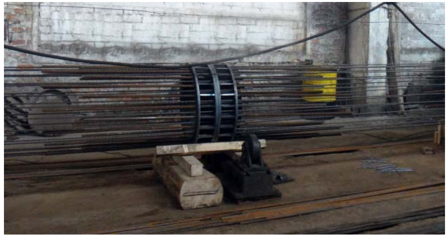
Рис. 1. Закладная деталь соединительного узла в арматурном каркасе стойки
