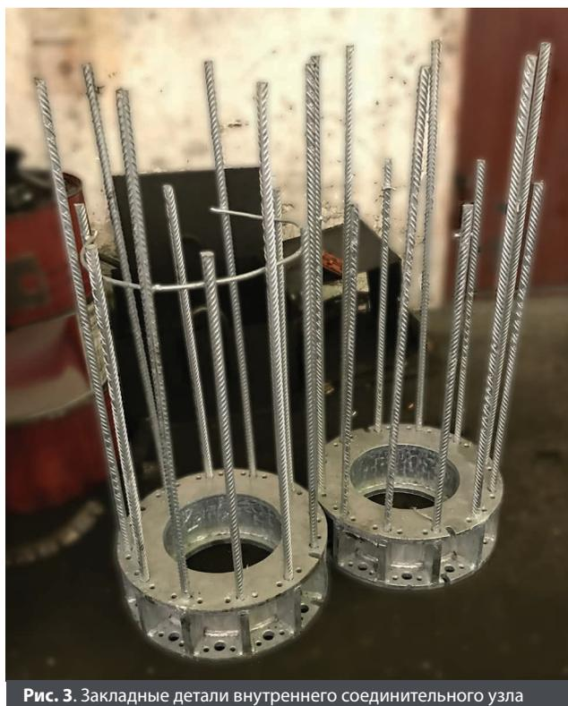
Рис. 3. Закладные детали внутреннего соединительного узла
