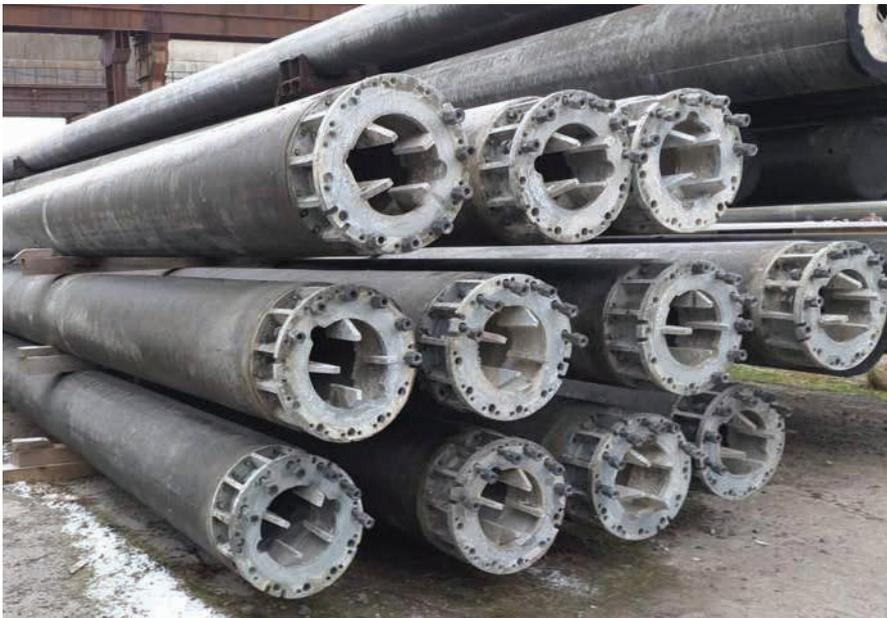
Рис. 4. Стойки с соединительными элементами, обеспечивающими проектную ориентацию секций
