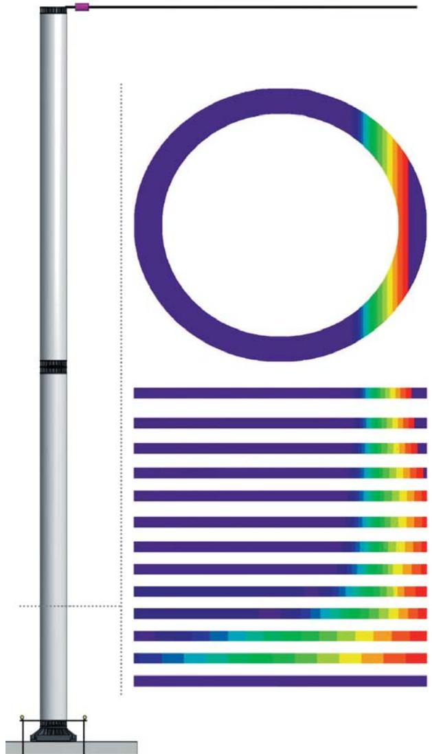
Рис. 2. Эпюры напряженного состояния бетона
