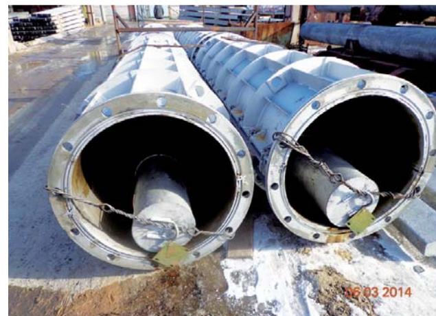
Рис. 3. Металлоформы для изготовления железобетонных centrifугированных секций диаметром 800 мм на заводе «Рыбинскэнергожелезобетон», г. Рыбинск
