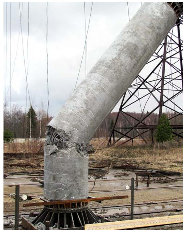
Рис. 3. Разрушение стойки при нагрузке в 160% от расчетного значения. Полигон в Хотьково 24 апреля 2015 года
