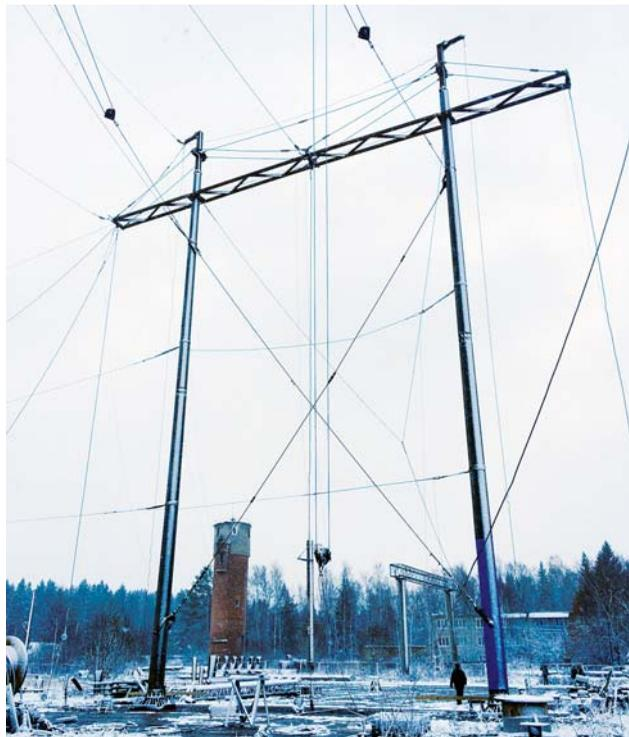
Рис. 2. Общий вид опоры, подготовленной к испытаниям
