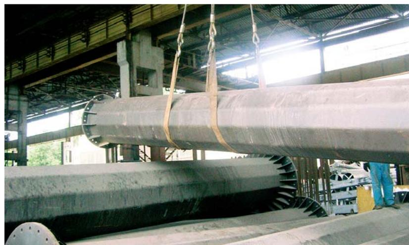
Рис. 3. Процесс складирования фундаментов из свай-оболочек многогранного сечения в заводских условиях
