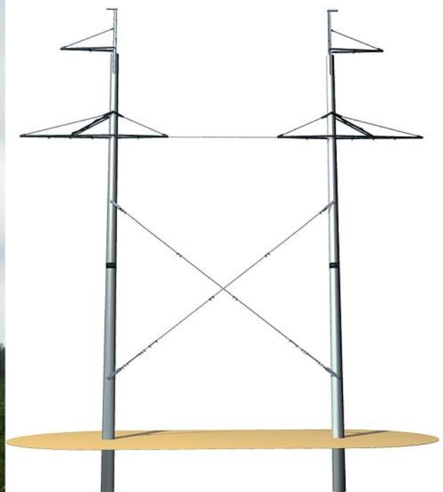
Рис. 2. Разработка опоры ПБД220-2К(с) для замены опоры ПБД220-2 на ВЛ 220 кВ Костромская ГРЭС — Кострома
