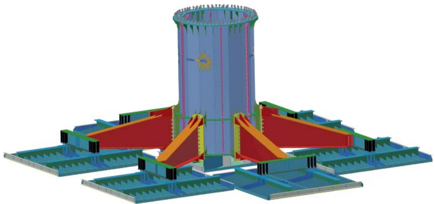
Рис. 1. Фундамент из ортотропных плит для высотных многогранных опор ВЛ 220 кВ
