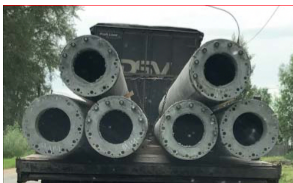
Рис. 1 а) Узел соединения секций. б) Перевозка секций длиной по 13 м
