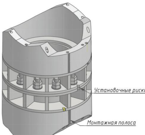
Использование бетона повышенного класса прочности (B60 вместо B40 или B30), водонепроницаемости (W14 вместо W8) и морозостойкости ( $F_1=1400$  и выше вместо  $F_1=1200$ ) повышает долговечность стоек до 70 лет, что практически исключает потребность в их ремонтах при эксплуатации.
